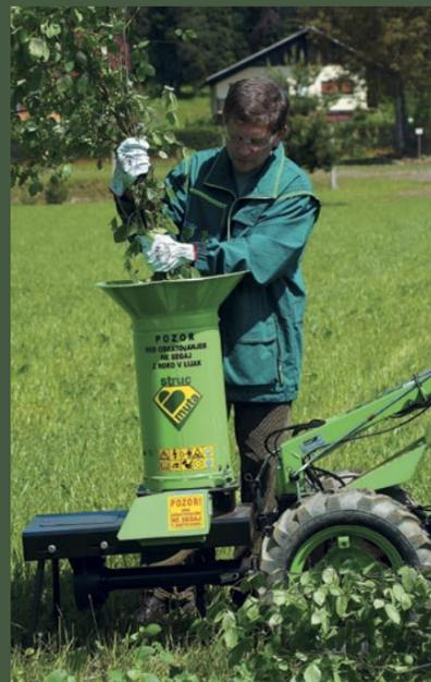
Auch zur Basismaschinen können Häcksler mit Multiplikatorgetriebe und Schneidesystem mit vier Schneiden angeschlossen werden. Die Kraft des Elektromotors beträgt 2,2 kw.
