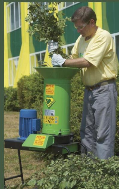
Mit dem selbstständigen Häcksler **MAX** mit dreiphasigem Elektromotor (2,2 kw) können auch größere Mengen von Überresten zerkleinert werden.
